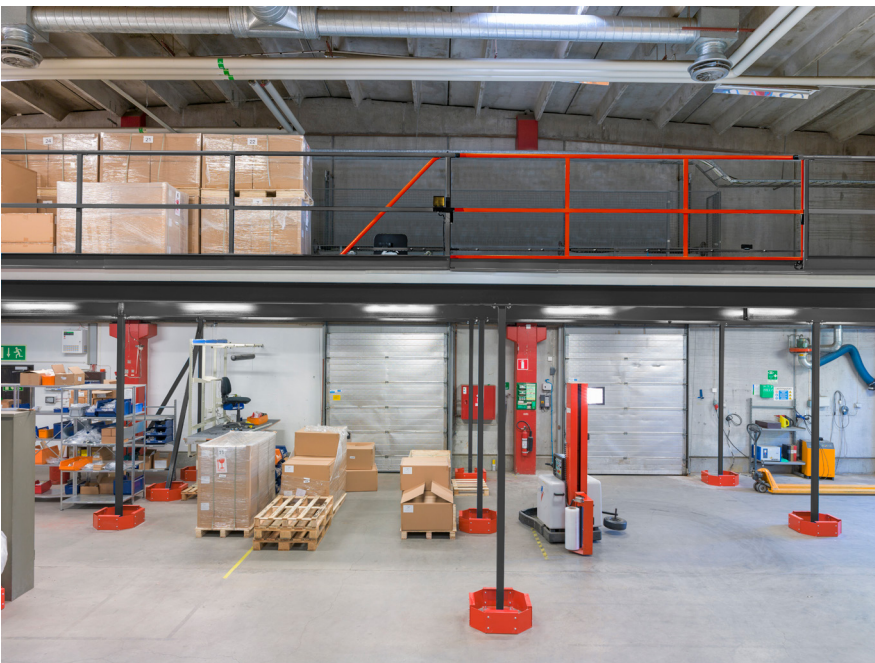
Upplastningsplats med motordriven skjutgrind. Manövrerad via radiosändare
